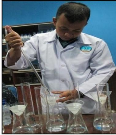
Gambar 5. Penyaringan sampel sedimen layang
