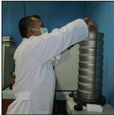
Gambar 10. Penuangan butiran sedimen ke dalam *sieve shakers*
